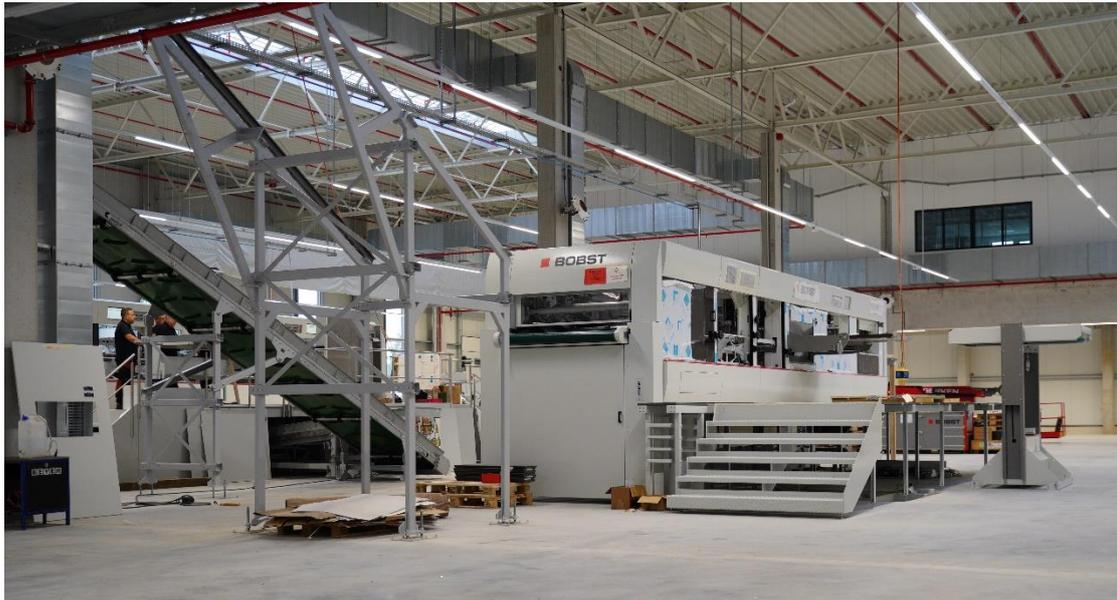
Abbildung 16: 23.08.2021 Anbindung der zweiten Stanzmaschine an das Förderband
