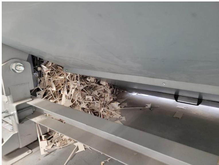
Abbildung 18: 26.11.2021 Abfälle aus Fehlabbwurf unterhalb der Maschine
