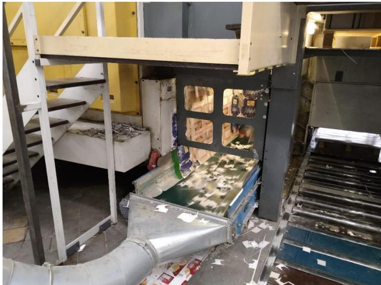
Abbildung 4: Ausbrechstation mit Abfällen, die der Absauganlage zugeführt werden.
