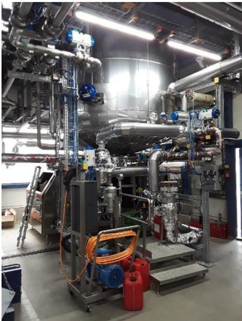
**Abbildung 5: Reaktor C309 mit Dispax und Homogenisator**
