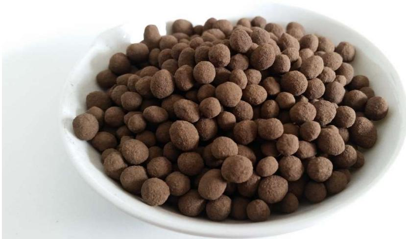
**Abbildung 20:** Klärschlamm-Reformer-Asche in granulierter Form
