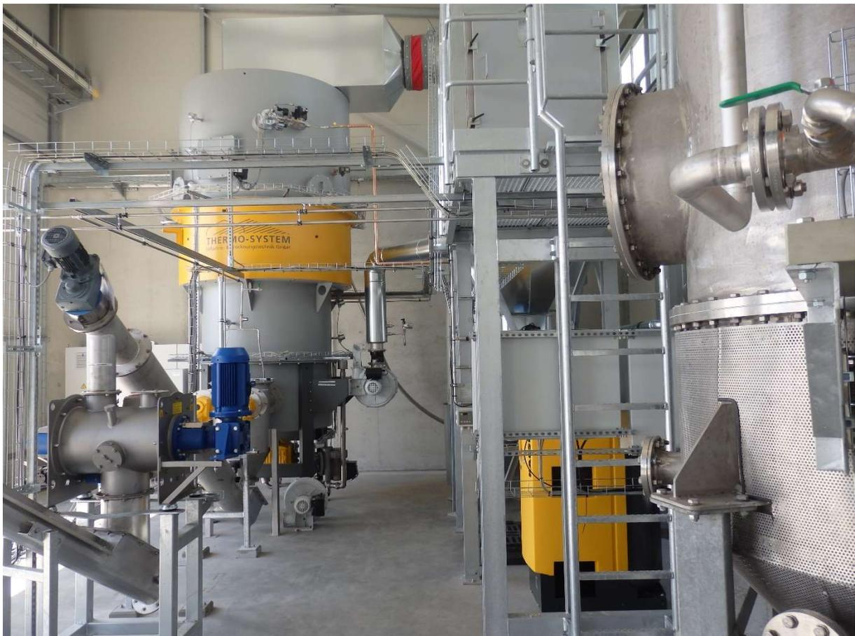
**Abbildung 7:** KLÄRSCHLAMMREFORMER mit Rauchgasreinigung
