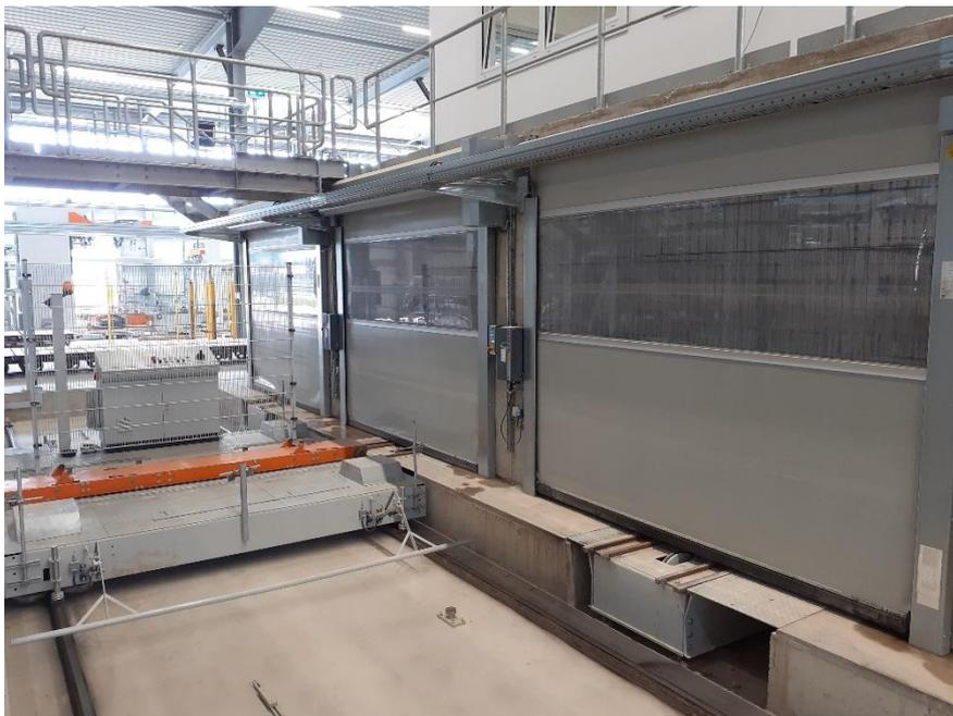
**Abbildung 11: Wärmetunnel mit automatischen Schnelllauftoren**
