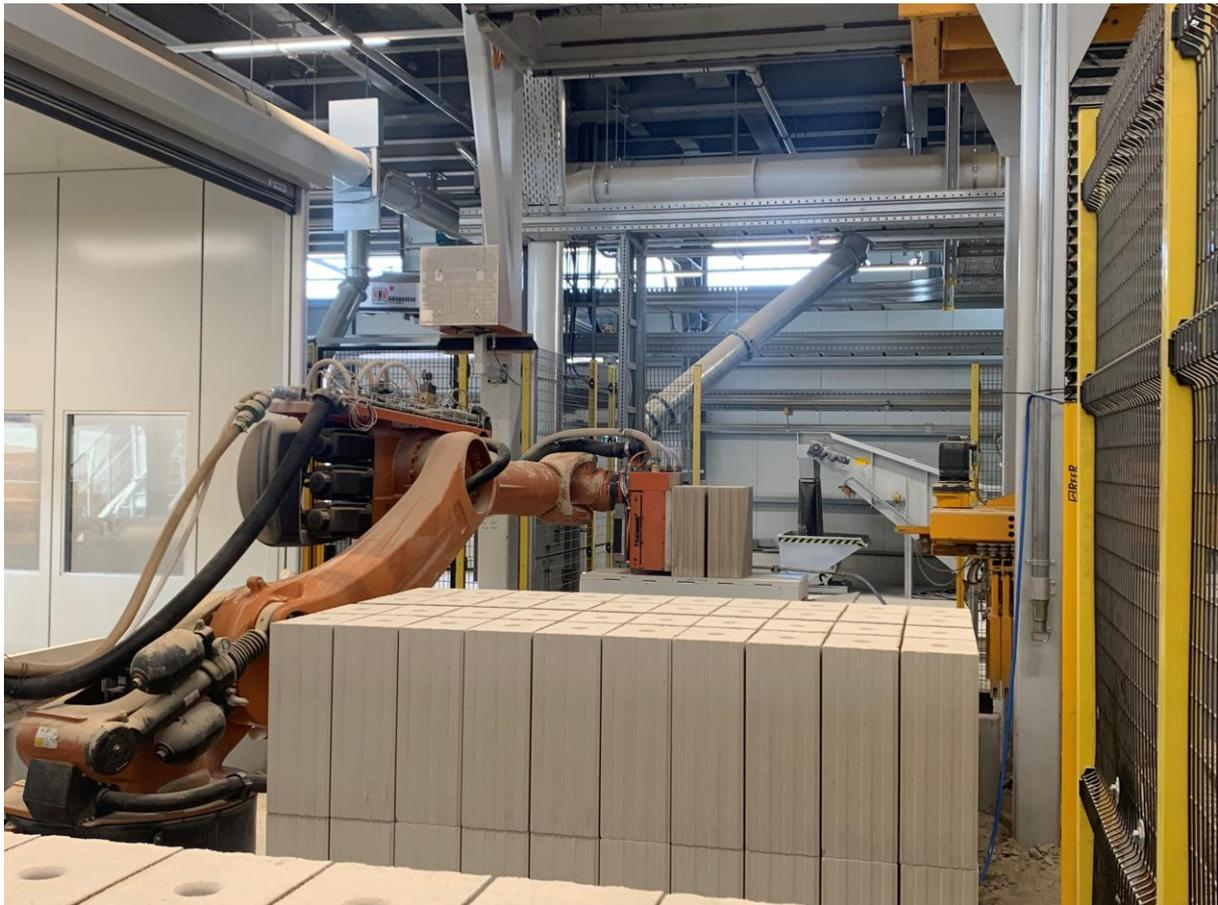
**Abbildung 10: Roboter der Sägeanlage**
