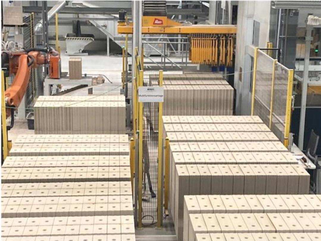
**Abbildung 9: Multifunktionsanlage bestehend aus Presse und Säge**
