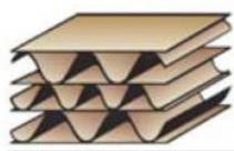
Abbildung 40: Wellenarten für Wellpappenverpackungen
