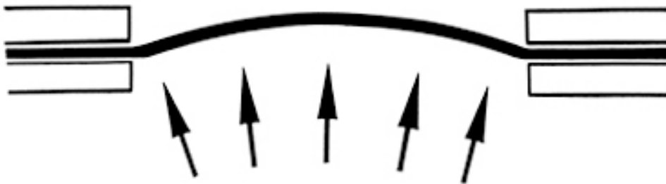
Abbildung 36: Messverfahren Berstfestigkeit (Quelle: https://www.wellpappe-wissen.de/wissen/qualitaetssicherung/papierpruefung/berstfestigkeit.html )
