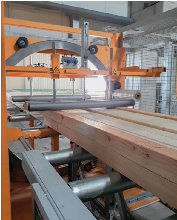
Abbildung 4: Wetterfestes Verpacken der Pakete durch den Wickelautomat
