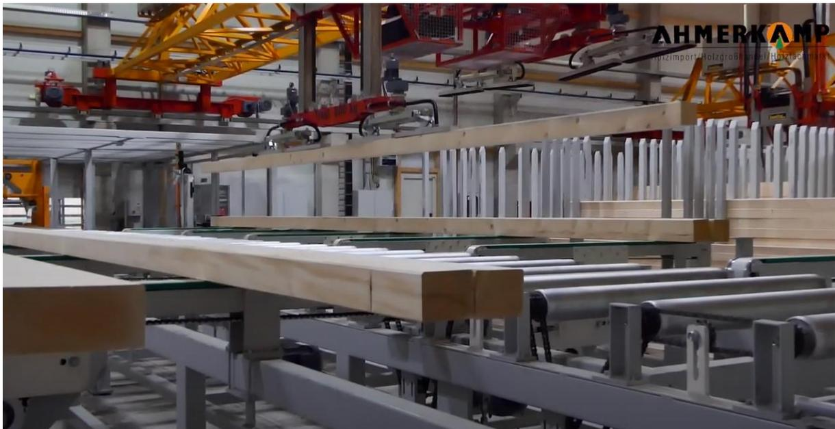
**Abbildung 3: Exemplarisches Beispiel wie die Vakuumlasteraufnahmen, auf den Katzen, einen Holzbalken aufnimmt (Quelle: Video von Ahmerkamp [Holz Ahmerkamp automatisierte Lagerhaltung - YouTube](#))**
