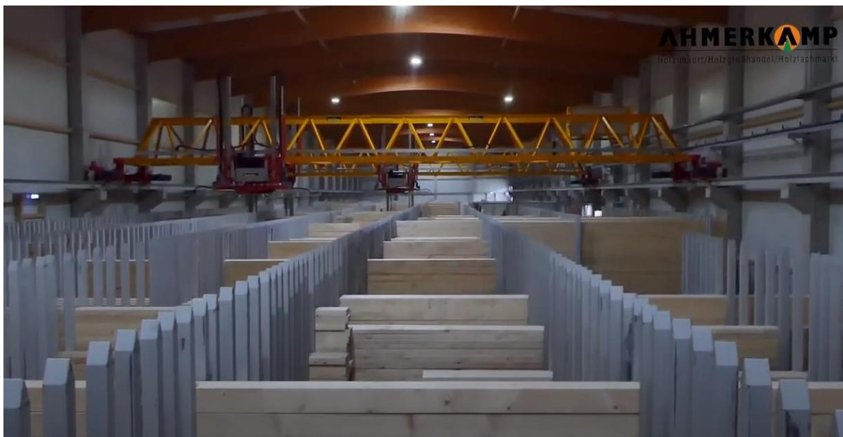
Abbildung 5: Darstellung des Holzlagers, aus dem die Katzen die benötigten Längen zusammenstellen (Quelle: Video von Ahmerkamp [Holz Ahmerkamp automatisierte Lagerhaltung - YouTube](#))
