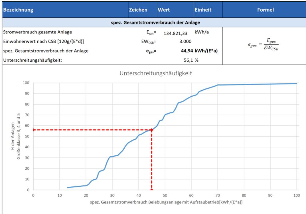
Abbildung 30: Vergleichsanalyse gesamter Energieverbrauch innovative SBR ohne CBR-Steuerung gemäß Energiecheck DWA-A 216
