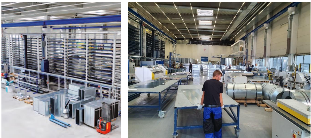
Abbildung 21: Platzsparendes, vollautomatisches Hochregallager in der Mitte der Produktionshalle
