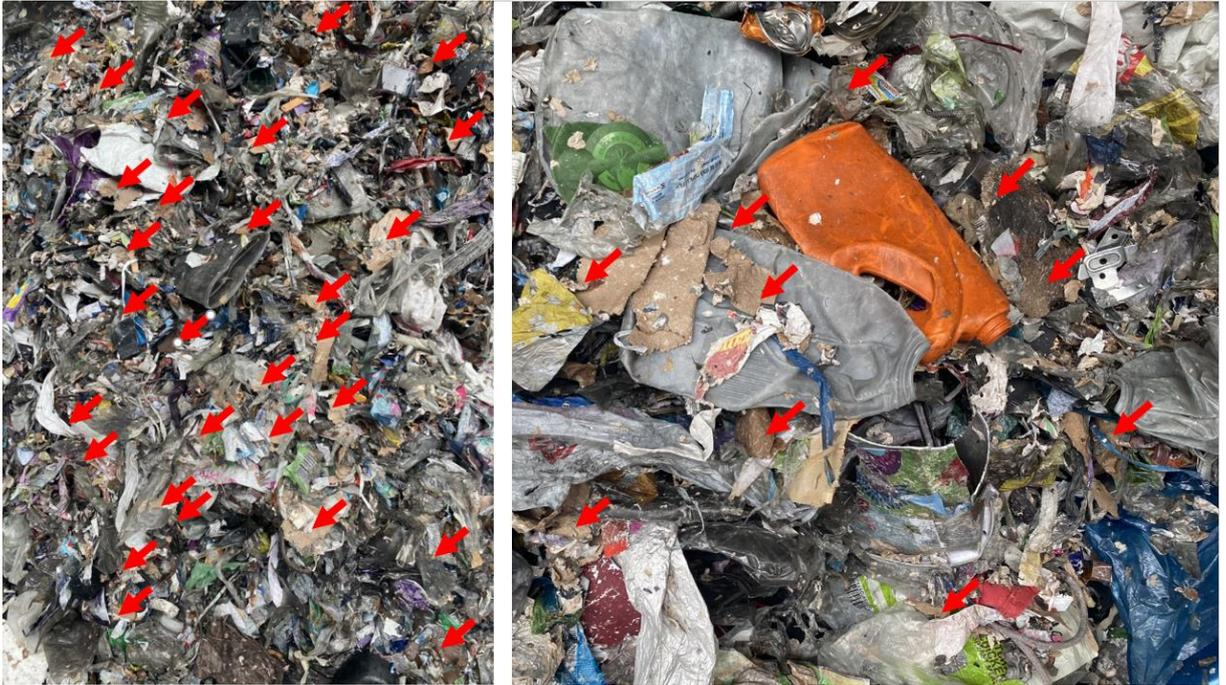
Abbildung 26: Rejekt Werk Aalen alt (PM 4/5) 2017 mit teilweise noch großen unauflösten Faserbündel und Papierreste, die zur Entsorgung gingen.
