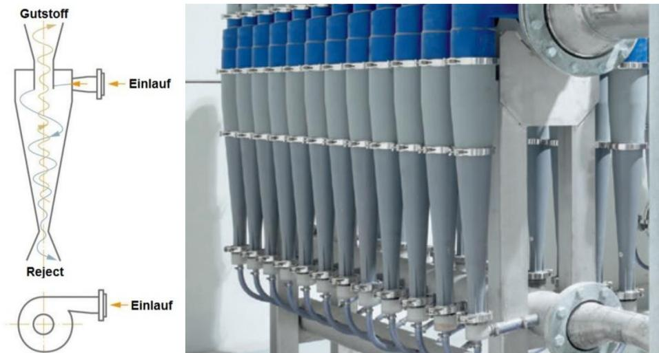
Abbildung 15: links- Funktionsskizze eines Cleaners, rechts- Moderne Cleaner in einer Parallelanordnung (papier-machen.de, 2023 )
