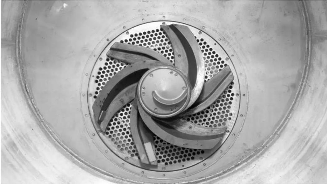
Abbildung 8: Lochblech und Rotor eines LC Pulpers (Voith GmbH & Co. KGaA, 2023)
