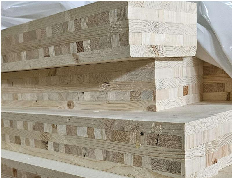
Abbildung 8: Brettsperrholzelemente mit Recycling-Lamellen in den Querlagen (Mittellagen)<sup>8</sup>
