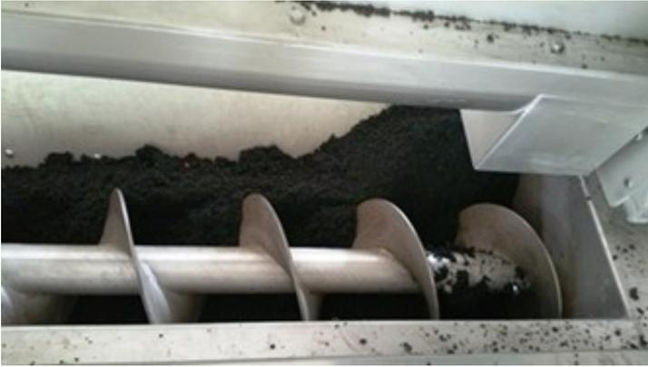
Abbildung 4: Aufgabe des entwässerten Klärschlammes auf dem Oberband des Bandtrockners über die Verteilschnecke
