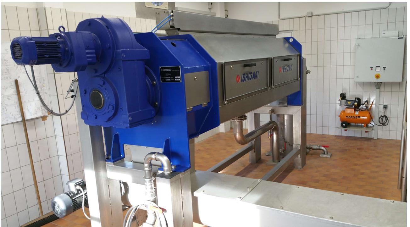
Abbildung 2: Foto der auf der KLA Linz-Unkel installierten Schneckenpresse IEA Typ SP-HF 05 XL (Quelle: ELIQUO STULZ)
