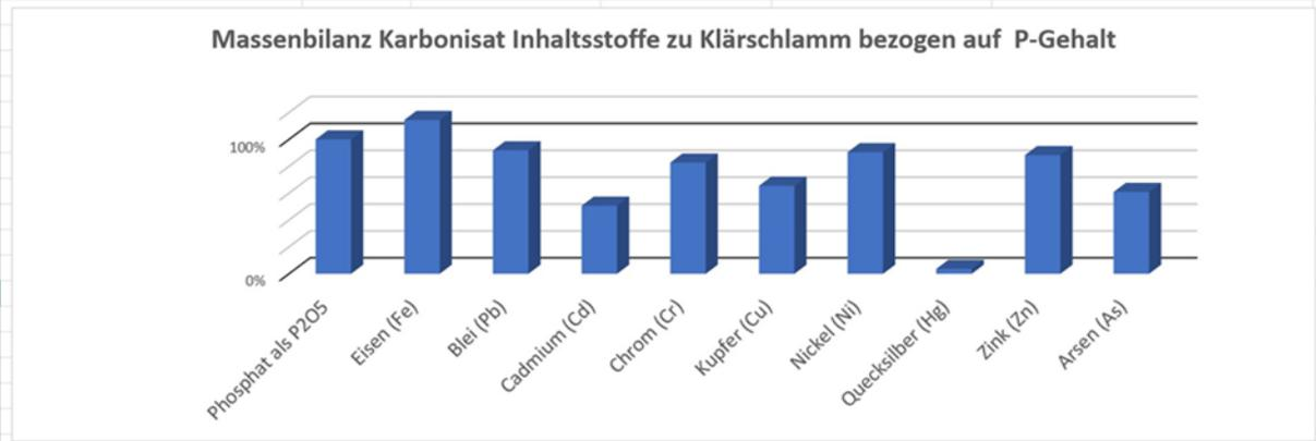
Die Daten zeigen, dass sich die untersuchten Schwermetalle im Karbonisat größtenteils, aufgrund der Massenreduktion um ca. 50 % während der Karbonisierung, auf etwa das Doppelte anreichern. Hingegen wird Quecksilber zu über 95% sowie Cadmium und Arsen um ca. 50% aus dem Feststoff eliminiert. Bezogen auf den düngerelevanten Phosphoranteil von Klärschlamm bzw. Karbonisat erfolgt durch die Karbonisierung folglich eine Abreicherung des Klärschlamm bezogen auf diese drei Schwermetalle.
