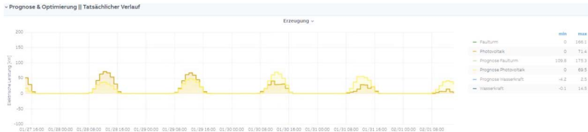
Abbildung 20: Prognostizierter und tatsächlicher Verlauf der Stromproduktion aus Photovoltaik im Energiemanagementsystem
