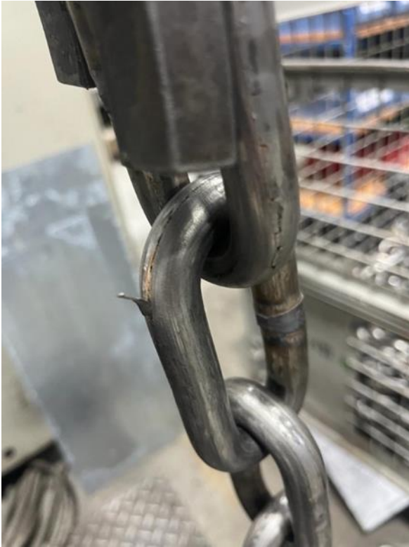
Abbildung 25: Spanabplatzer bei Überwalzungen im Draht. Je besser die Drahtqualität desto seltener Überwalzungen im Draht (Foto aus 2024)
