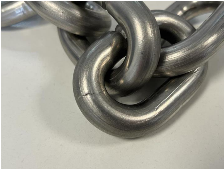
Abbildung 28: Riss / Bruch im Radius der Kette bei einer 16x48 Kette (Foto aus 2024)
