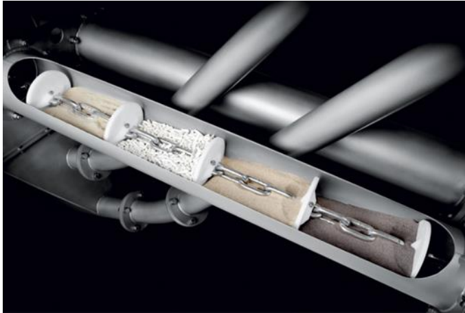
Abbildung 4: Darstellung eines Rohrkettenförderers
