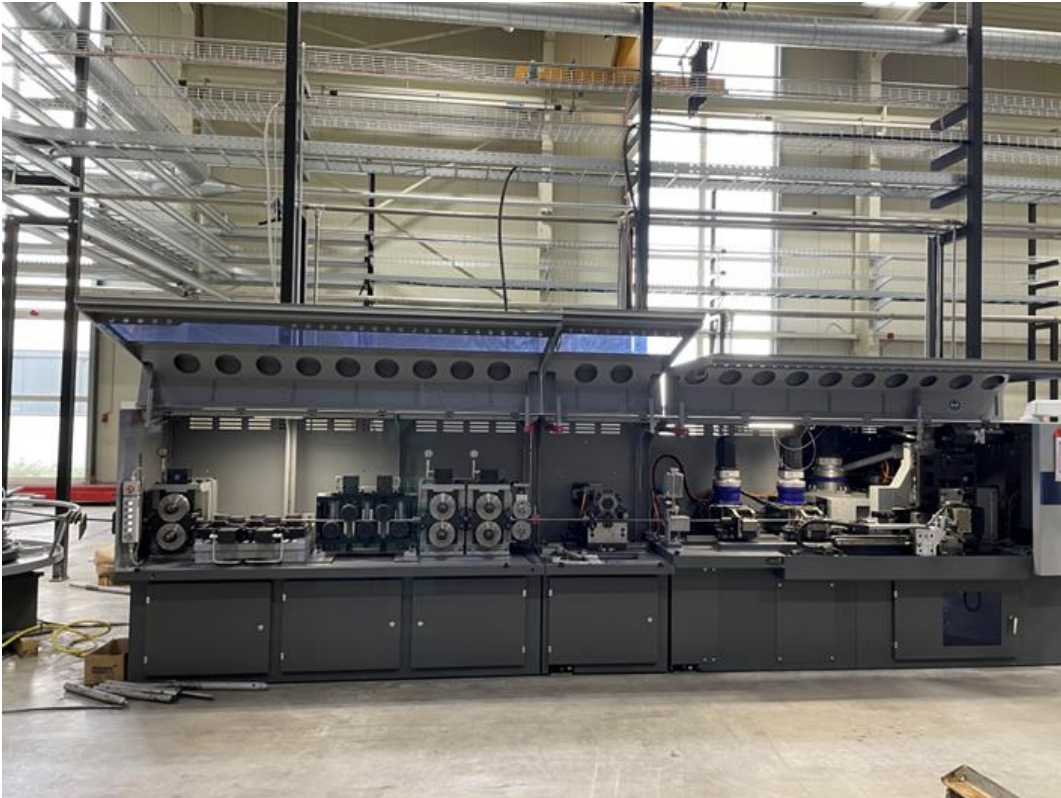
Abbildung 15: Kettenbiegemaschine KER 7.2 Foto vom 17.03.2023 links – Richtwerk; rechts - Rollbiegeeinheit
