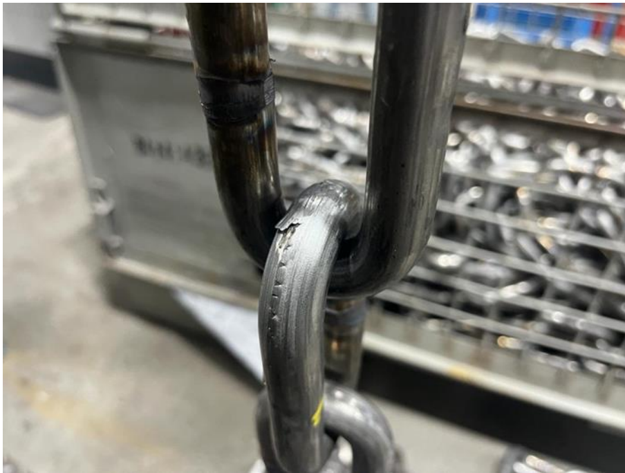
Abbildung 27: Materialaufplatzer bei einer 16x80 Kette (Foto aus 2024)
