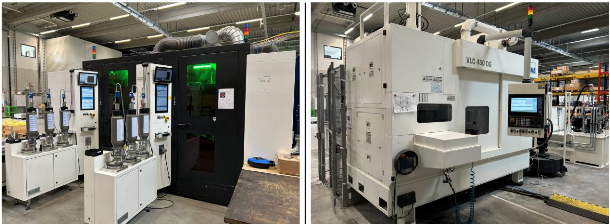
Abbildung 2-2: Setup Alsdorf (links: EHLA TWIN Beschichtungszelle / rechts: Schleifanlage)
