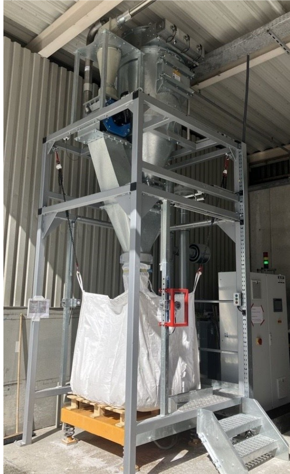
Abbildung 31: Perlit-Rückgewinnungsanlage mit Big Bag
