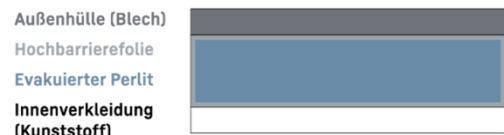
Abbildung 34: Aufbau Vakuumisolation BluRoX
