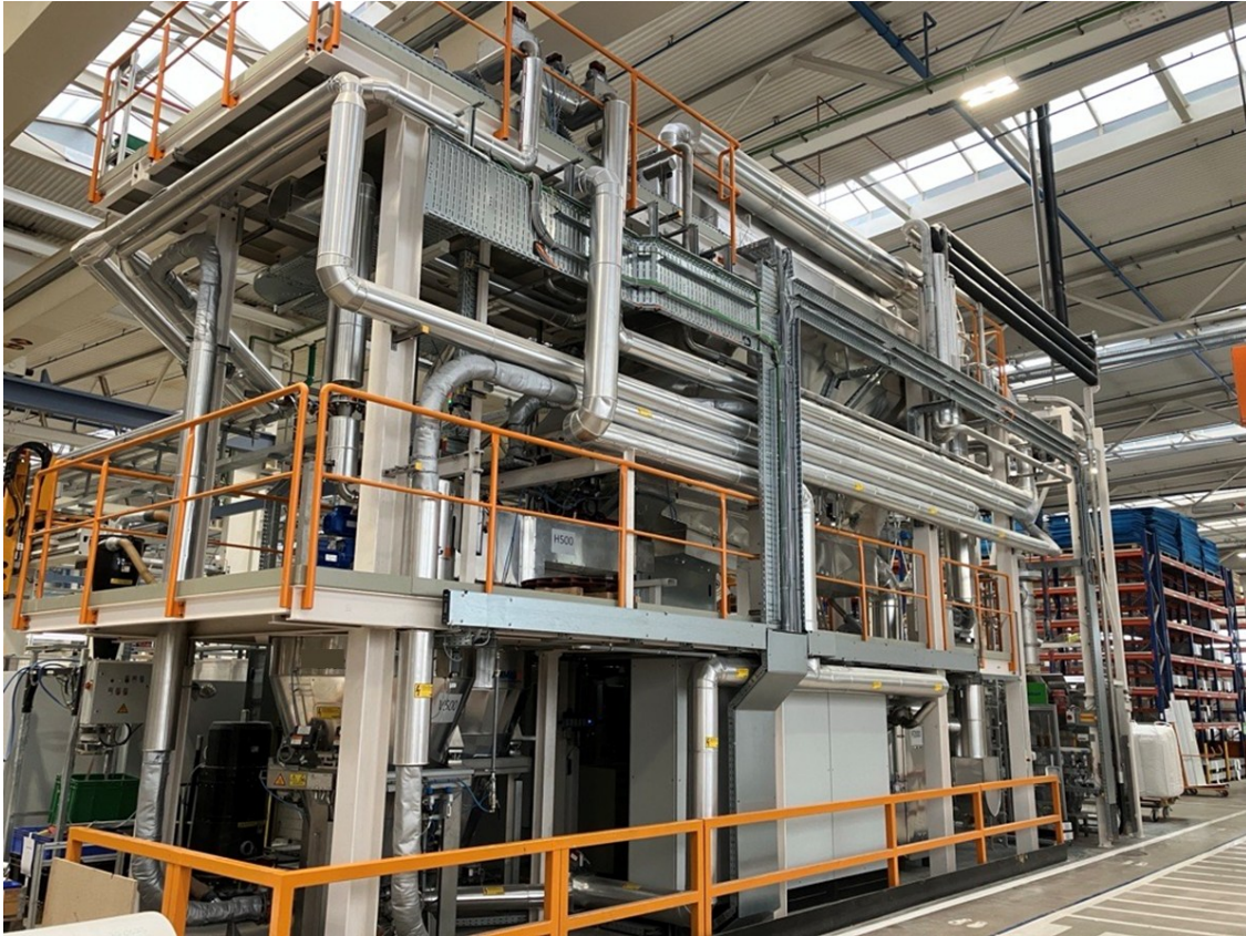
Abbildung 8: Wirbelschichtanlage zur Perlitkonditionierung
