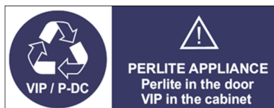
Abbildung 28: Genormte Kennzeichnung PU-Schaum/VIP-Geräte mit BluRoX-Tür
