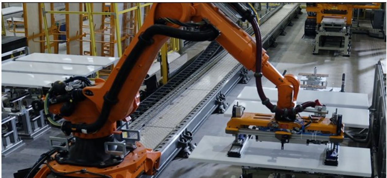
Abbildung 14: Türen nach der Deckschichtanbringung auf den Evakuierplätzen
