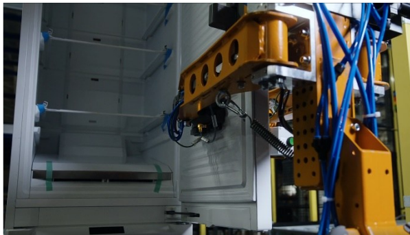
Abbildung 17: Anbringung eines Wärmestromsensors an der Gerätetür mithilfe des Handlinggeräts
