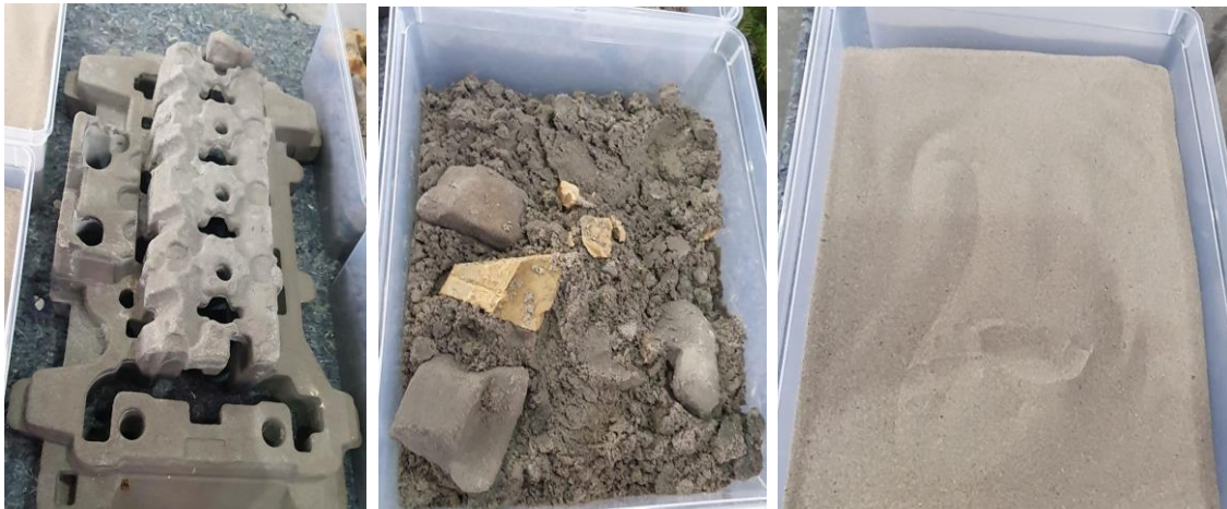
Abb. 5 Fotos vom Ausgangsstoff zum Produkt. Links der Sandkern eines Zylinderblocks, in der Mitte der vom Knollenbrecher zerkleinerte Sandkern (Altsand) und rechts der aufbereitete Regeneratsand.
