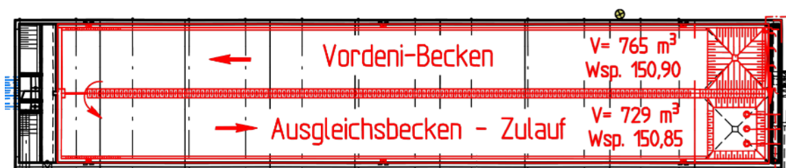
Abbildung 25: Hybrides Konzept zur Nutzung einer Kammer des Ausgleichsbeckens zur Vordenitrifikation oder zur Vorversäuerung [Ruhrverband]
