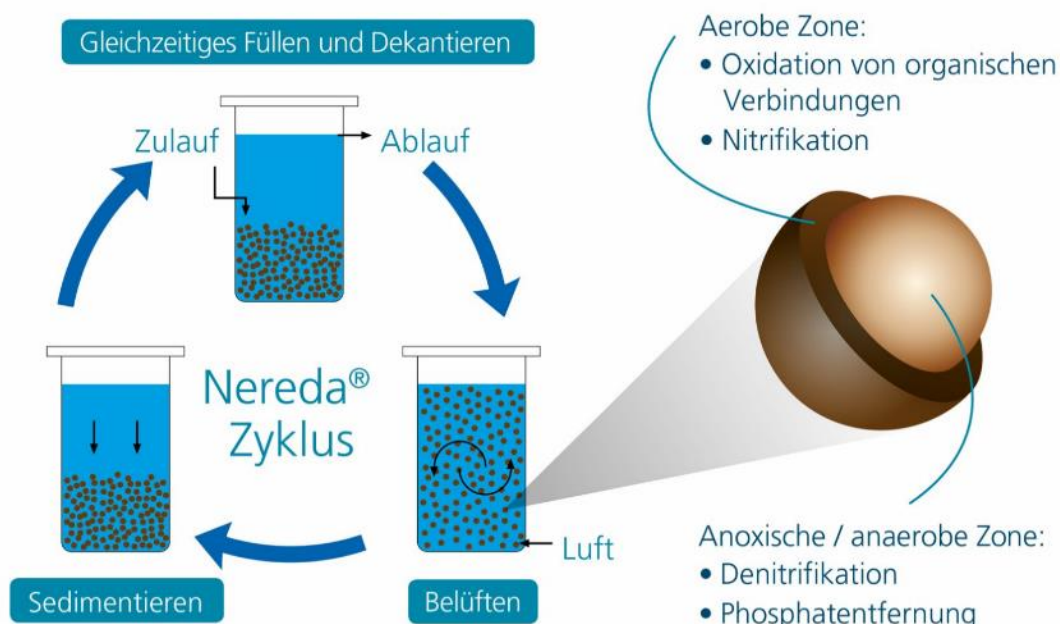
Abbildung 5: Prinzip-Schema des Nereda®-Verfahrens [Haskoning, [4]]
