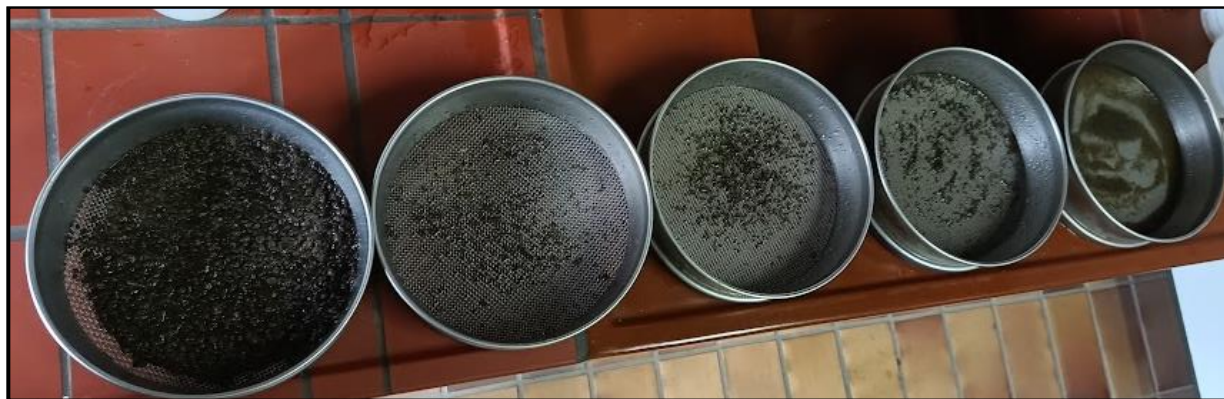
Abbildung 19: Nasssiegung zur Ermittlung der Granulengrößenverteilung (Siebgrößen von links nach rechts: 1,8 mm; 1,4 mm; 1,0 mm; 0,6 mm; 0,2 mm) [Ruhrverband]
