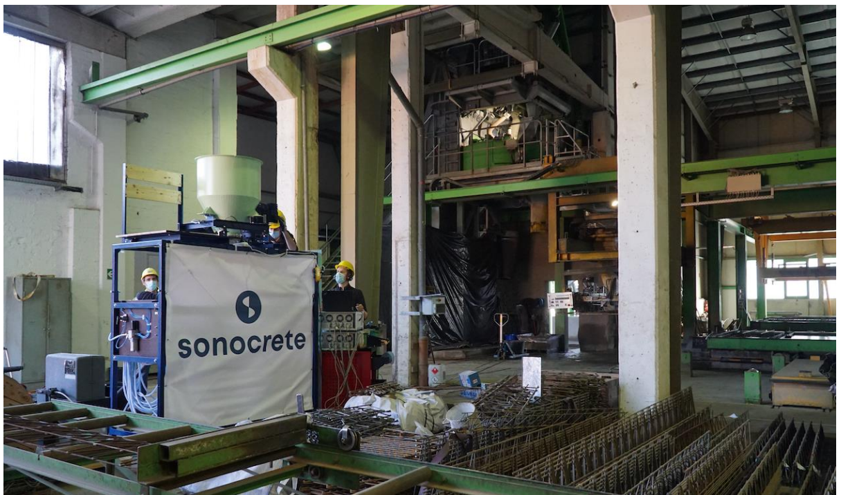
Bild 3: Erster Werksversuch mit einer Labor-Ultraschallanlage während des gemeinsamen KMU-Innovativ-Forschungsprojektes "UltraBePro" (Quelle: MATTIG & LINDNER)
