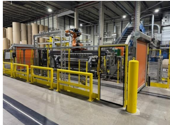
Abb. 4: iPrep Schälstation mit Robotertechnik
