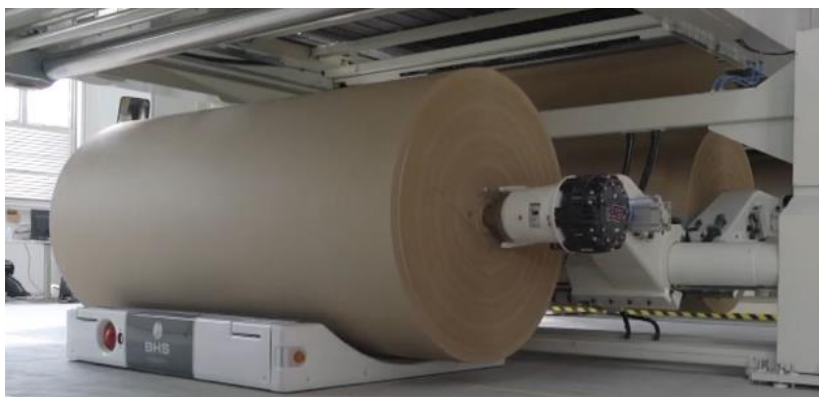
Abb. 7: Übergabe der Papierrolle nach dem automatischen Schälvorgang vom iShuttle an die WPA
