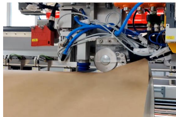
Abb. 6: Automatischer Schälvorgang der äußeren Papierbahn
