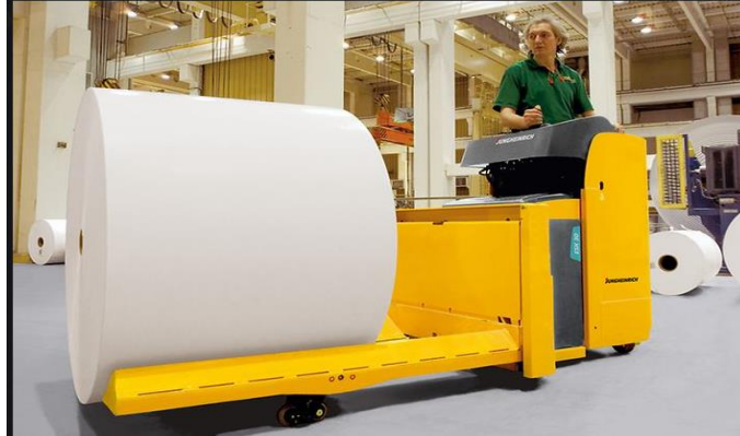
Abb. 1: Niederflrhubwagen zum konventionellen Transport von Papierrollen
